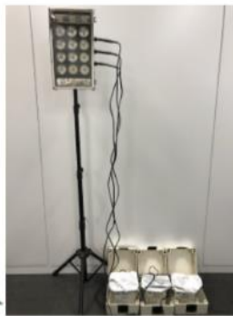
照明機器 (水電池による発電)
